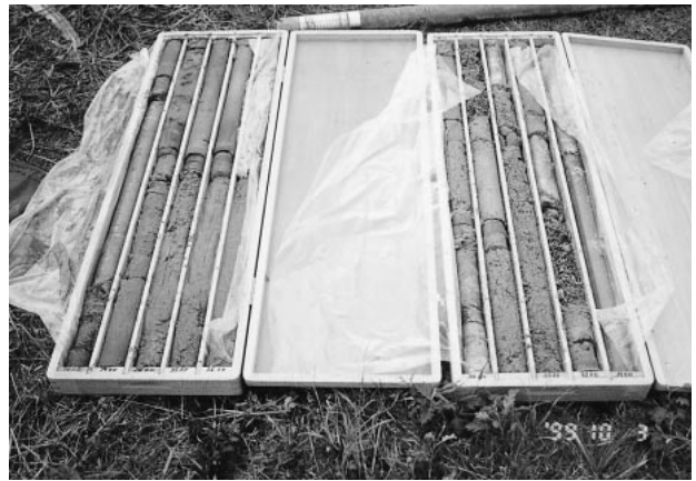
写真2 採取されたボーリングコアの沖積砂礫層
