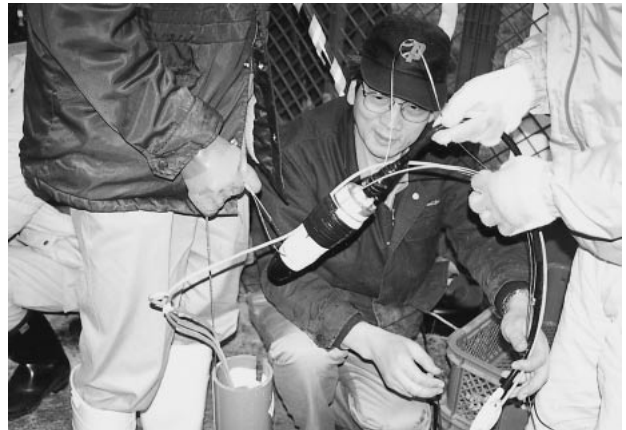
写真3 観測井へのCTセンサの設置
