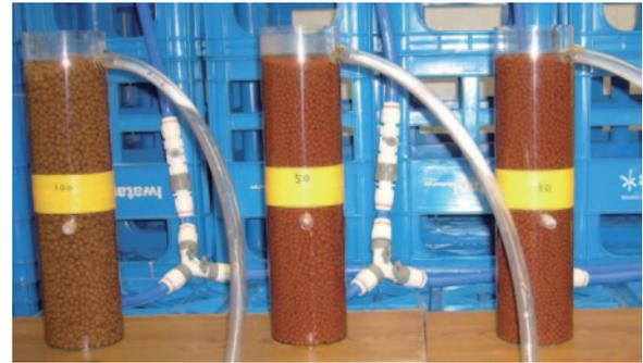
第6図 カラム試験の様子。「だんだんエコ玉」の赤色土・脱水ケーキの混合比を変えている。左から脱水ケーキの含有量が 100%, 50%, 30% である。
