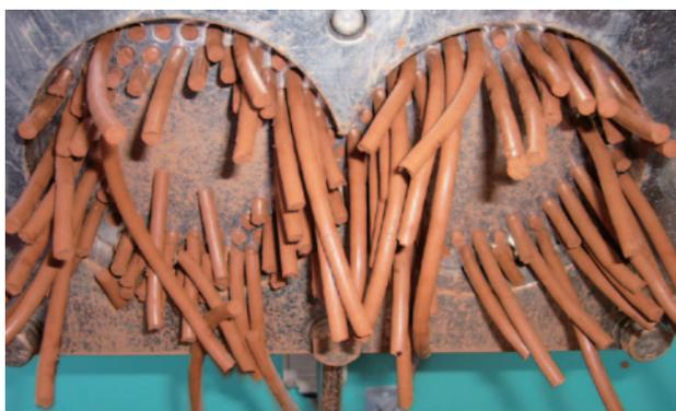
第2図 混合された赤色土・脱水ケーキ（マサ土の洗浄時に発生する粘土）をペレットライザーにかけペレットに加工している様子。
