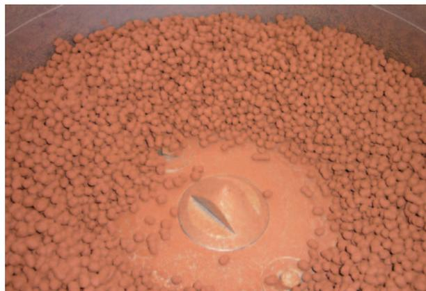
第3図 ペレット状の「だんだんエコ玉」の材料を丸めライザーにて造粒する様子。
