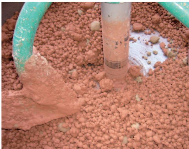
第1図 「だんだんエコ玉」の材料の赤色土と水の混合を示す。
