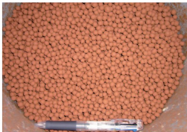
第4図 造粒された「だんだんエコ玉」, 乾燥後焼結して製品となる。
