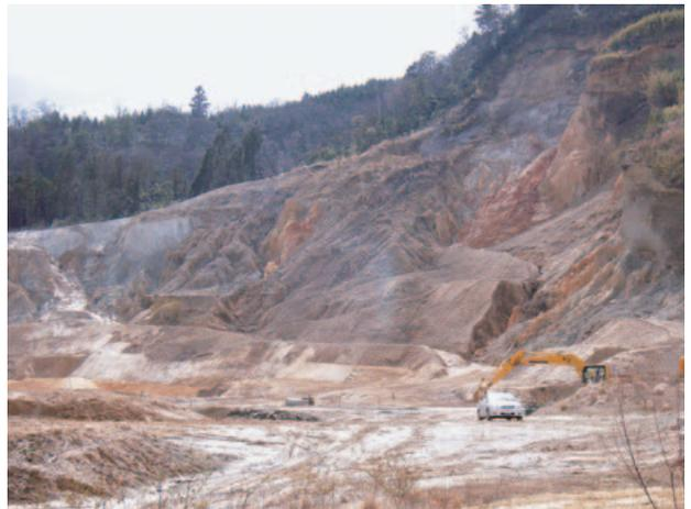
第10図 大田市温泉津町荻村～西田（三子山東麓）の三子山鉾山（瓢屋株）。重機で階段採掘されている。赤褐色の濃い部分も砂岩層で大江高山火山群のデイサイトによる熱水変質を被っている。
