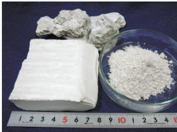
第4図 セリサイトの鉱石(変質した花崗岩)、中間製品(ケーキ)および製品粉末。
