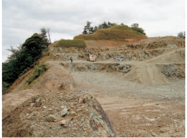
第8図 長谷鉾山最上部の採掘場。山の斜面を採掘しており、緑色～淡緑色の硬質のゼオライト岩（モルデナイト）を採掘している。鉾山下部ではガラス質流紋岩脈が多数貫入している。
