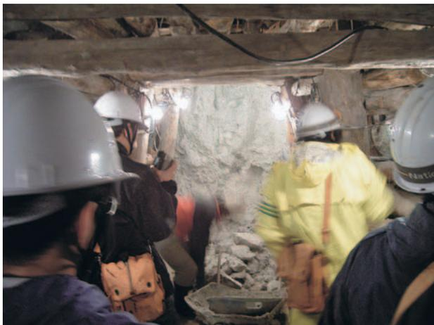
第3図 雲南市三刀屋の鍋山鉱山の-27.5 m準の切羽(斐川礦業(株))。木枠で支保され採掘後は埋め戻す工法を採用している。
