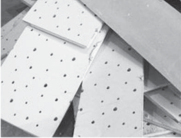
写真-1 廃石膏ボード
