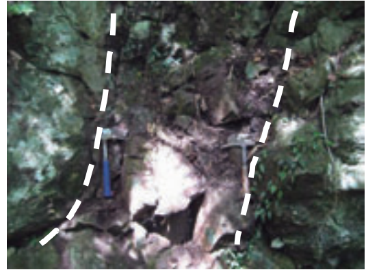
図13 層序関係写真（新庄・上宇部尾エリアの谷間） Gグループの岩石をRグループの岩石が貫入し ている。
