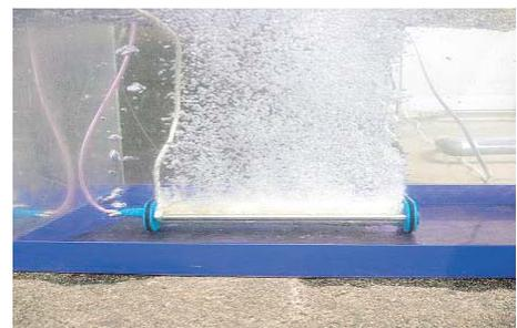
写真4：エアストーンによるミリバブルの発生
