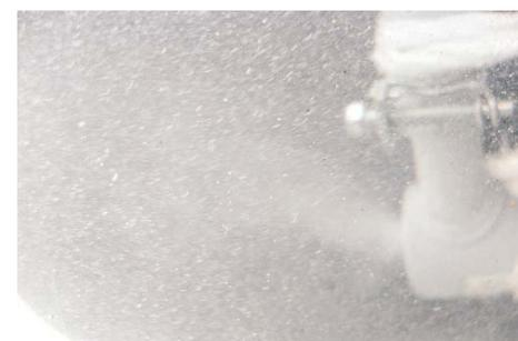
写真5：水道水でのマイクロバブルの発生
