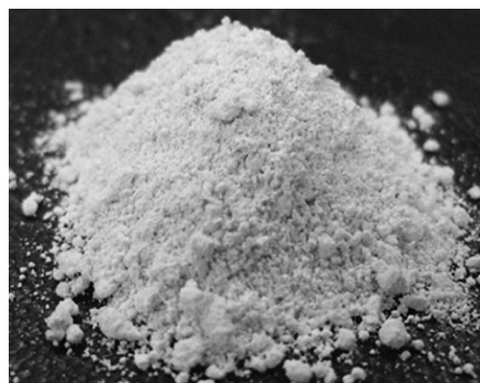
写真-2 半水石膏
