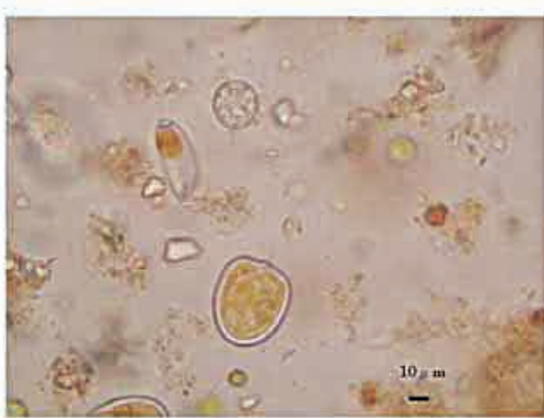
図10 入水管からの排泄物中の生物顕微鏡写真
