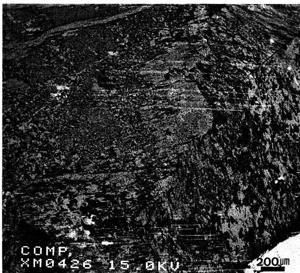
第2図 アルカリ長石の低倍率での反射電子線像(コンポ像)。左右二つのアルカリ長石が、ほぼ中央で、NE-SW方向に伸びる湾曲した境界をもって接している。より色の白い部分がよりOr成分に富み、より色の黒い部分がよりAb成分に富む。
