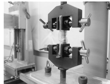
(b) 飽水小試験体の治具への取り付け状況。
