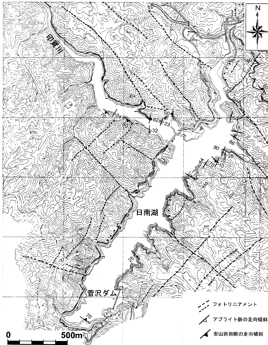
第4図 日南湖周辺の地形と photo lineaments. Photo lineament は 1/10,000 空中写真の判読による。また、確認したアプライト脈と岩脈の走向傾斜も示している。地形図は日南町地形図 (原縮尺 1/5,000, 等高線間隔 10 m) を使用。
