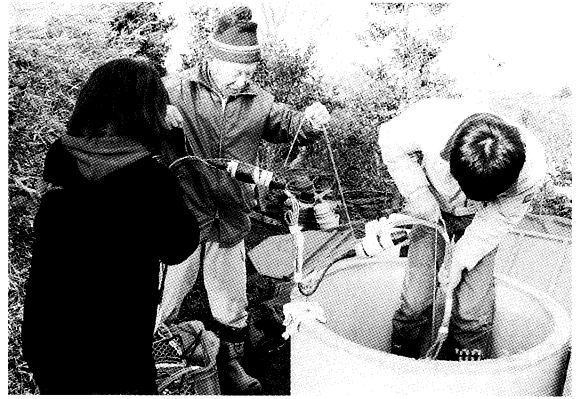
写真2 マルチCTセンサーの設置作業
