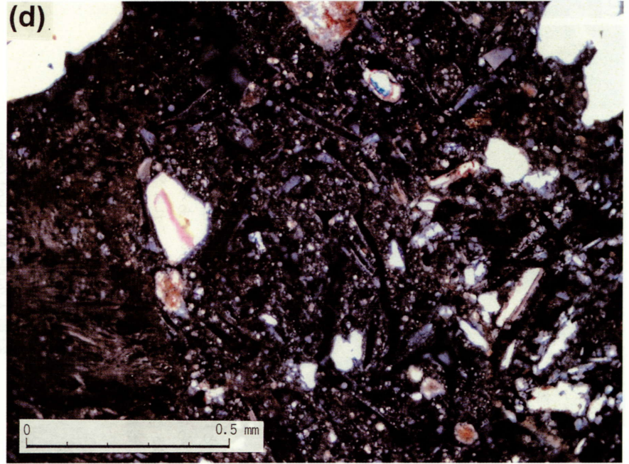
第6図 光学顕微鏡によるシラスのテクスチャ。いずれも試料はコアの深度約1 cmより採取。 (a) 深度1 cm, 単ニコル, (b) 深度1 cm, 直交ニコル, (c) 深度1 cm, 単ニコル, (d) 深度1 cm, 直交ニコル
