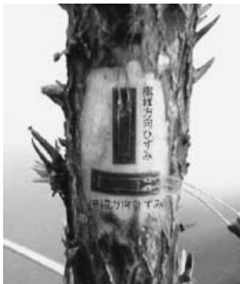
図. 2. 内樹皮表面に貼り付けたひずみゲージ。
