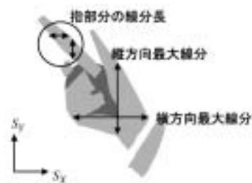
図5 ライン走査による線分長さの測定
