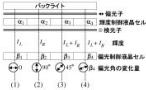
図 15 液晶セル 2 重積層構造による映像提示部 SUA-X
