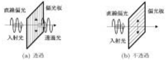
図 7 偏光板を用いた遮光バリア
