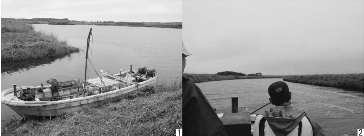
写真 1. 調査に使用した天塩漁協の船と儀装状況 (左舷に SC-3, 右舷にサイドスキャンソナーを設置, 背景は天塩川) 写真 2. サロベツ川を航行
