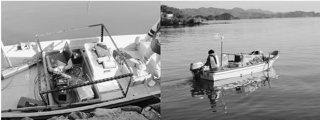
図5. 中海本庄水域におけるサイドスキャンソナーの実験風景 写真中、(1)サイドスキャンソナー、(2)サイドスキャンソナー用ノートPC、(3)ナビゲーション用ノートパソコン、(4)DGPS受信機、(5)サイドスキャンソナー、(6) DGPS受信機、をそれぞれ示す。
