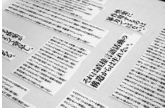
図7：写植によって制作した版下
