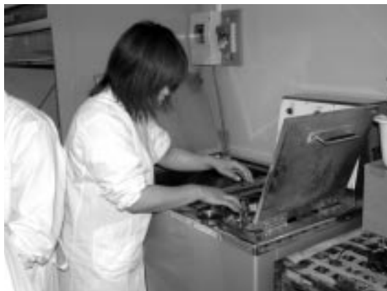
図4 ラウンドオメータを用いて、人工汚染布の洗浄試験を行っている実験の様子
