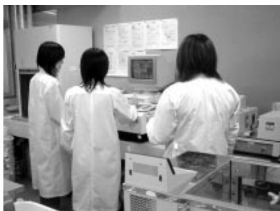
図5 分光光度計を用いて、洗浄効率を測定している実験の様子
