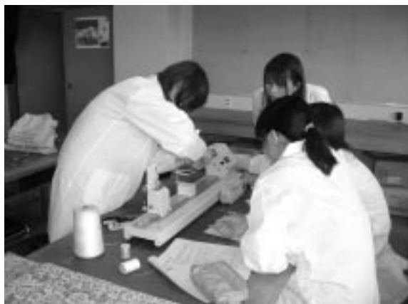
図1 撚糸装置を用いて、撚り数、撚り縮み率、撚り方向を求めている実験の様子
