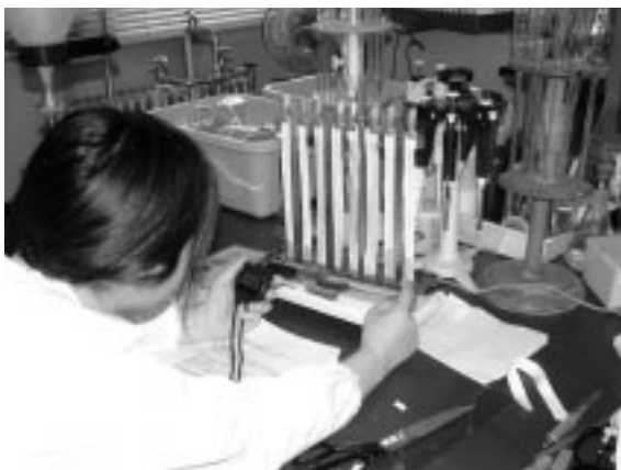
図3 パイレック式吸水度測定装置を用いて、布地への吸水性を求めている実験の様子
