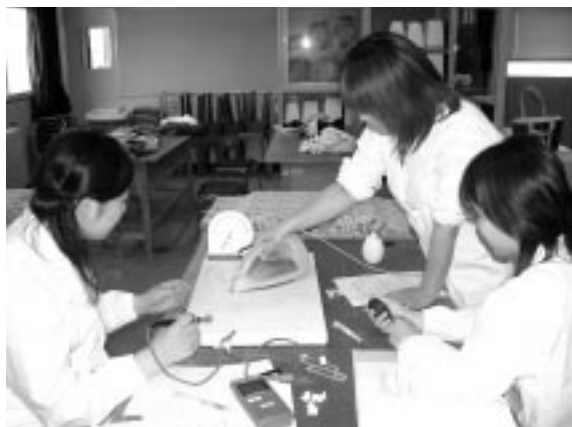
図6 モンサント法によって、家庭用アイロンでの折り目付け効果を評価している実験の様子
