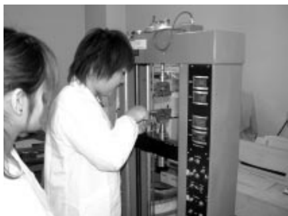
図2 引張り試験機を用いて、糸の引張り、引掛け、結節強さと伸び率を求めている実験の様子
