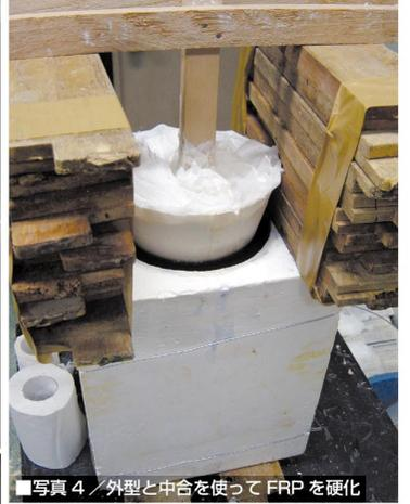
■写真4 / 外型と中合を使ってFRPを硬化
