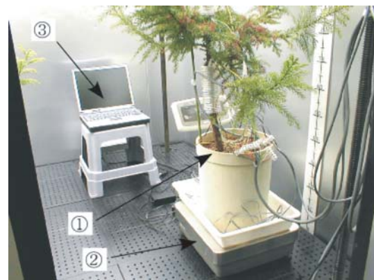
Fig. 2. 重量法による蒸散量の測定風景。
