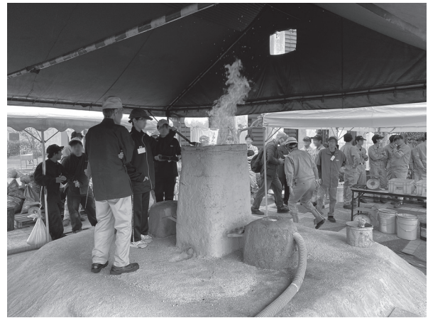
全学基礎教育科目「たたらと現代製鋼」 安来市和鋼博物館の古代たたら復元実験で製鉄炉に 砂鉄を投入する学生（R5.10.7）
