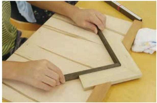
【図 24】「額の制作」の様子。治具にガイドをあて、木枠を添わして張り付けることで正確な直角が得られる。
