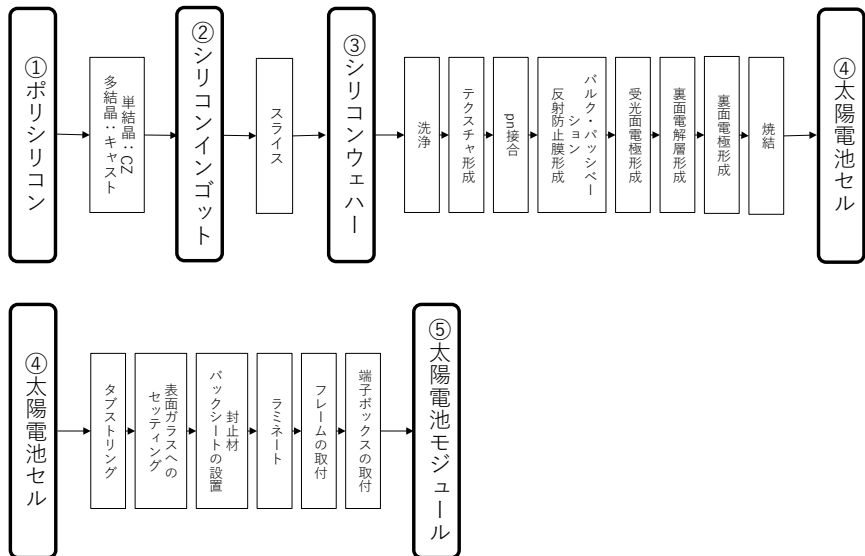
図 ポリシリコンから太陽電池モジュールまでの製造工程
