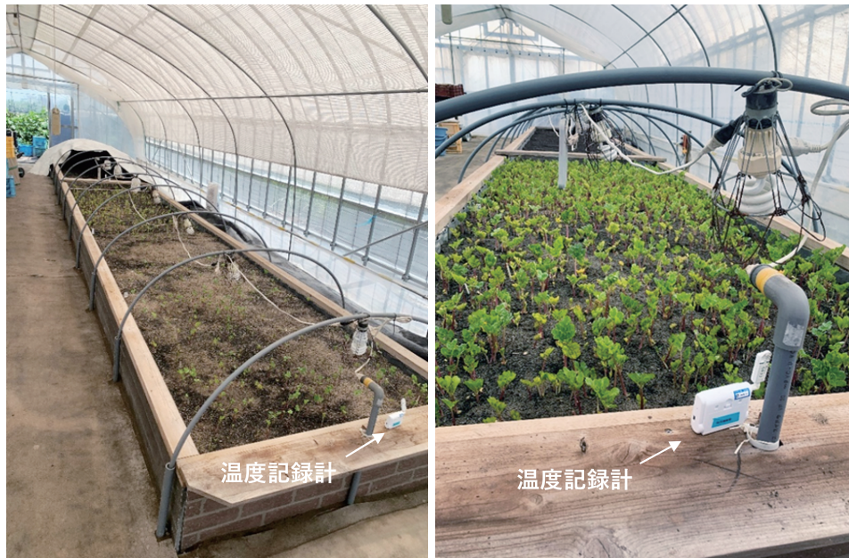
Fig. 2 温度記録計の設置風景
