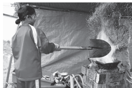
図6. たたら炉の操業中. 砂鉄を生徒が投入している。地面を掘り下げて炉の高さを下げ、投入しやすくしてある。シャベルの下にジョウゴが見える。
