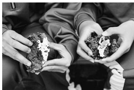
図9. 得られた鋳塊。どちらも金属光沢を示している。
