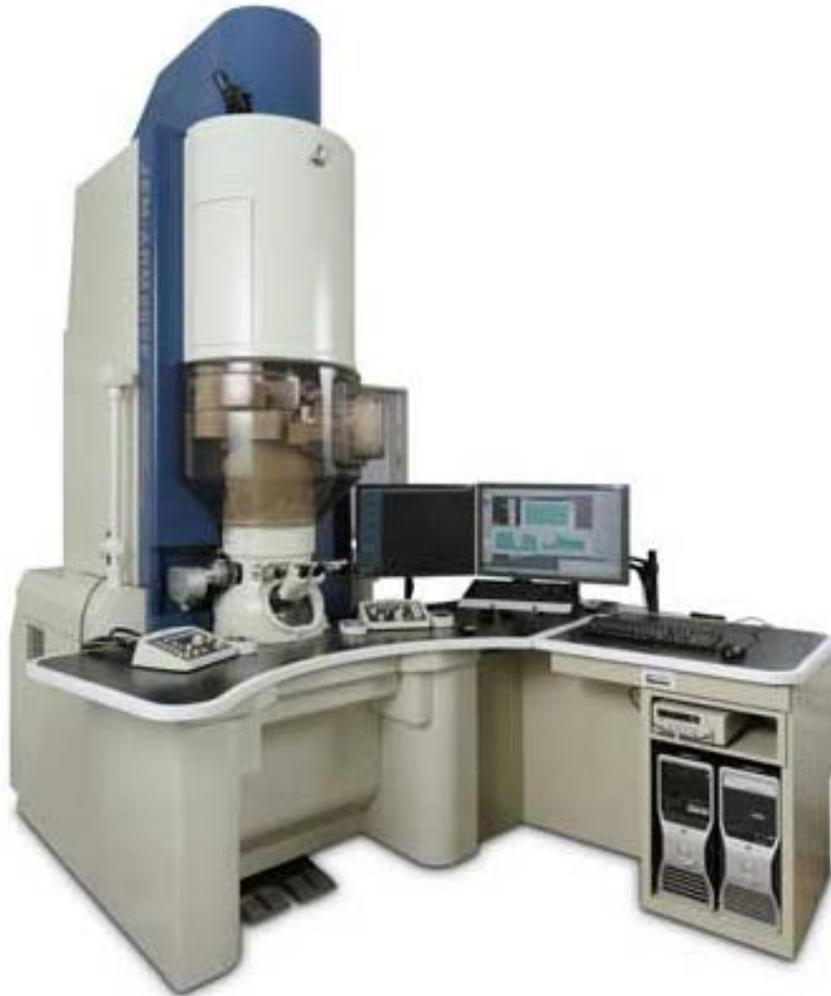
図 3-4 京都大学化学研究所にある球面収差補正レンズおよびモノクロメーター搭載の STEM-EELS
