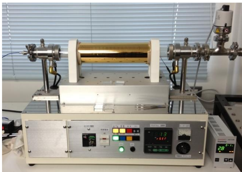
図 2-3 アニール装置 (ゴールドファーネス) の外観
