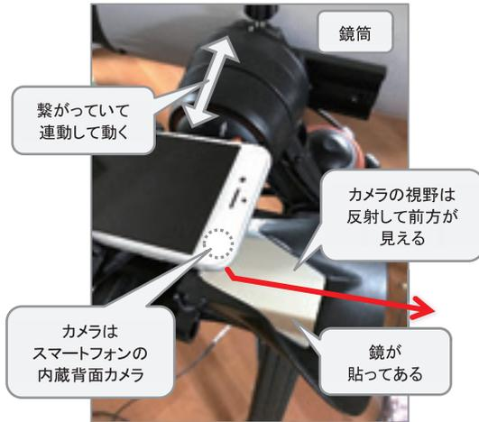
写真4. StarSense Explorerのスマートフォン設置部
