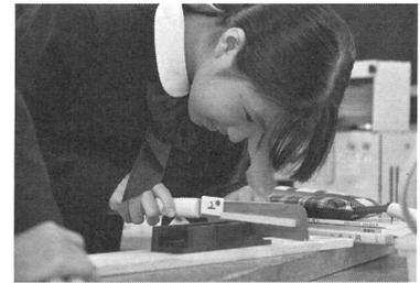
二種類のアブダクションを受けて最適な方法を検討した。検討に際しては図のようにホワイトボードを活用し、個々の生徒が形状等を図解しながら話し合いを行った。これらの話し合いにより、「三種類の異なる切れ幅の鋸で切れ目を入れることが最適ではないか」という意見が示された。実際の作業は三種類の異なるあさりの鋸を用意し、下の写真のような鋸刃を誘導する切れ目のついた治具（ガイドブロック）を用い垂直度を正確に切り込み、さらに切れ目の深さを決めるため切断深さのストッパーとしての役目をする棒材を鋸身に接着し加工を行った。
