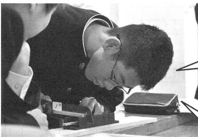
鋸身に棒材を貼り付けて、それ以上切り込めないようにし、切り込みの深さを調整する。3種類の異なるあさり及び切り込み深さの鋸を用意した。
