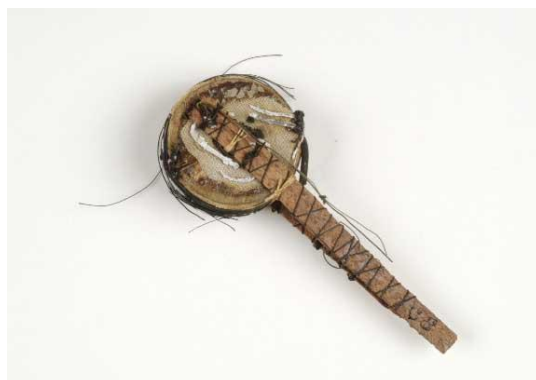
図 1-22 Onnes が試作した鉛製超伝導磁石 [55] 。
