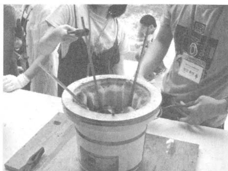
図2-14 棒材を焼鈍している様子
