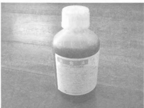
図3-15 腐食液(塩化第二鉄溶液)
