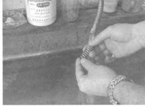
図 3-18 腐食液を洗い流している様子
