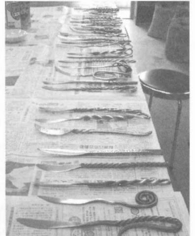
図2-20 塗料でコーティングして完成
