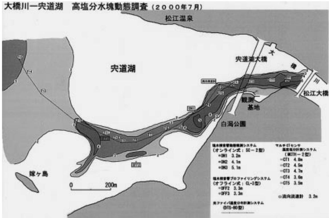
図1 大橋川から宍道湖にかけての連続観測の機器設置位置と湖底地形(地形は島根県土木部による宍道湖大橋改修工事測深図および1万分の1湖沼図宍道湖をもとに作成)
