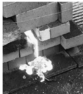
図 10. ノロを排出している状況。レンガ上面の黒色は吹き出した砂鉄の堆積による。
