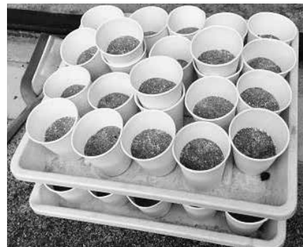
図 7. 1 回分用に小分けした砂鉄と石灰の混合物
