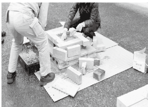
図 2. 耐火レンガ製たたら炉の下部構造. 波状トタン板の上に砂をまき、その上に炉を構築
