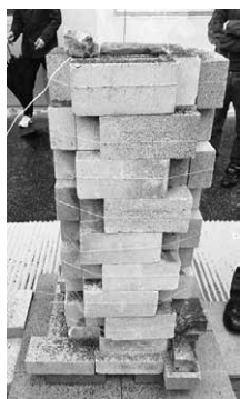
図 9. 操業中のたたら炉。炎が上部から出ており、レンガには吹き出た砂鉄が蓄積している。
