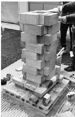
図 5. 完成したたたら炉. 耐火レンガの継ぎ目を覆う形に外側のレンガを配置してある. レンガ自体は針金で外周を巻いて固定した.
