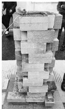
図 9. 操業中のたたら炉。炎が上部から出ており、レンガには吹き出した砂鉄が蓄積している。
