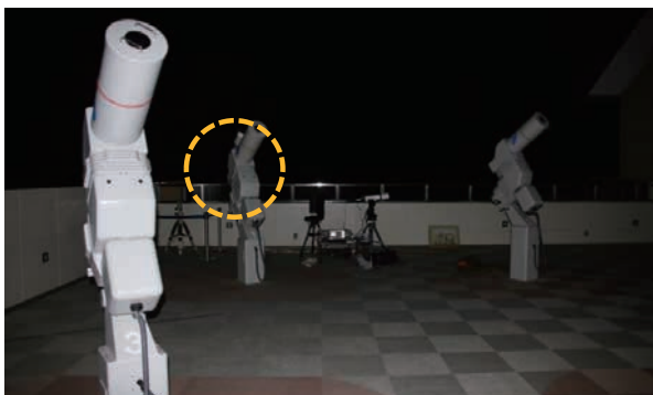
写真5 屋根が開いた状態での20cmクーデ式望遠鏡
