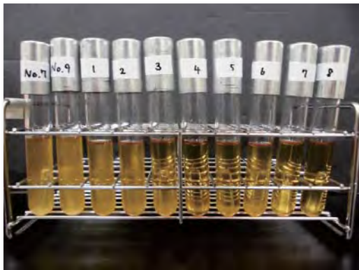
図 1. ダーラム管を用いた二酸化炭素生成試験
