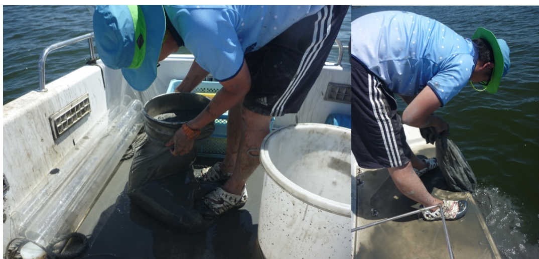
Figure 3-4. 船上での篩分けの様子 (左側：ステンレス篩+プランクトンネット、右側：水中で篩う様子)
