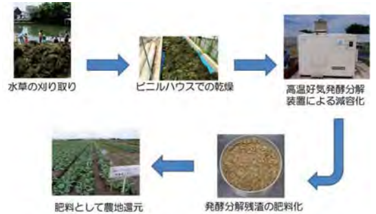
図1. 宍道湖に発生する水草の減容化・肥料化のスキーム
