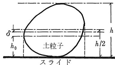
図1. 顕微鏡写真撮影面の高さ
