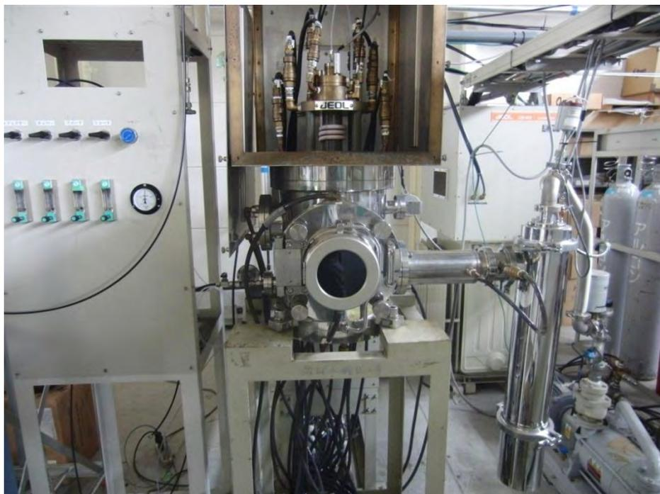
図 3.1 高周波熱プラズマ装置(日本電子社製 : JHS-35M).
