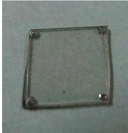
図 2.4 電極配置後の試料の写真。
