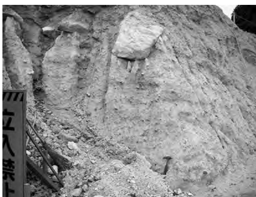
第14図 古期扇状地堆積物。非常にルーズで淘汰の悪い礫混じり砂から構成され、巨礫～細礫サイズの大江山デイスイトの亜円礫を含む。撮影位置は第4図参照。
