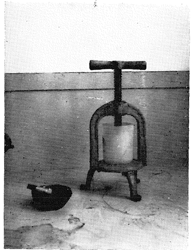
(写真2) 水銀から鉄粉の圧搾分離
