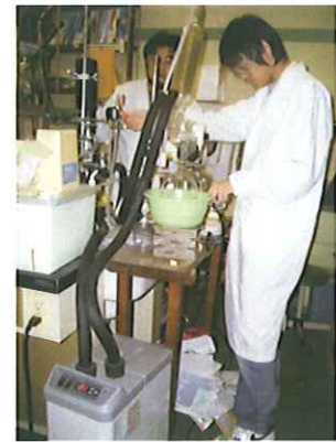
写真11 導入した溶媒回収装置
