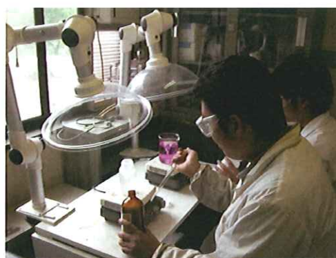
写真45 小型局所排気装置
