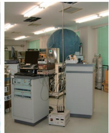
写真31 磁化測定装置MPMS
