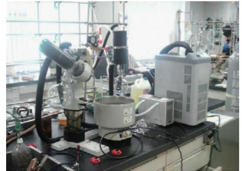
写真13 導入した溶媒回収装置
