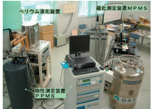
写真29 低温実験室の装置群
