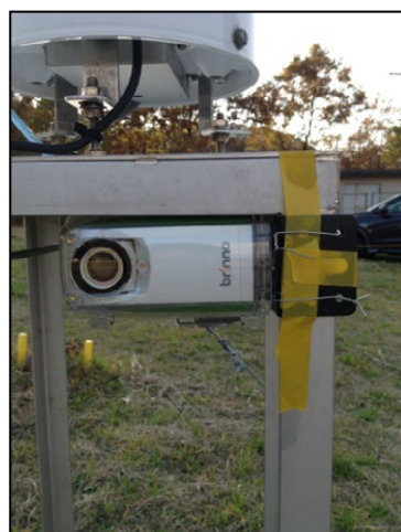
図1 超音波積雪深計・雪尺（上図）と雪尺を撮影するインターバルカメラ（下図）
