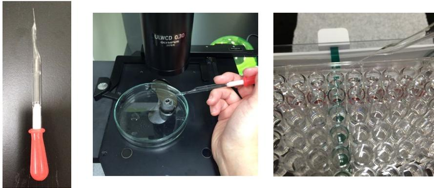
左: マイクロピペット。ゾウリムシ用よりも先がかなり細い。中: 実体顕微鏡下での単離。右: 単離細胞培養のための96穴プレート。
