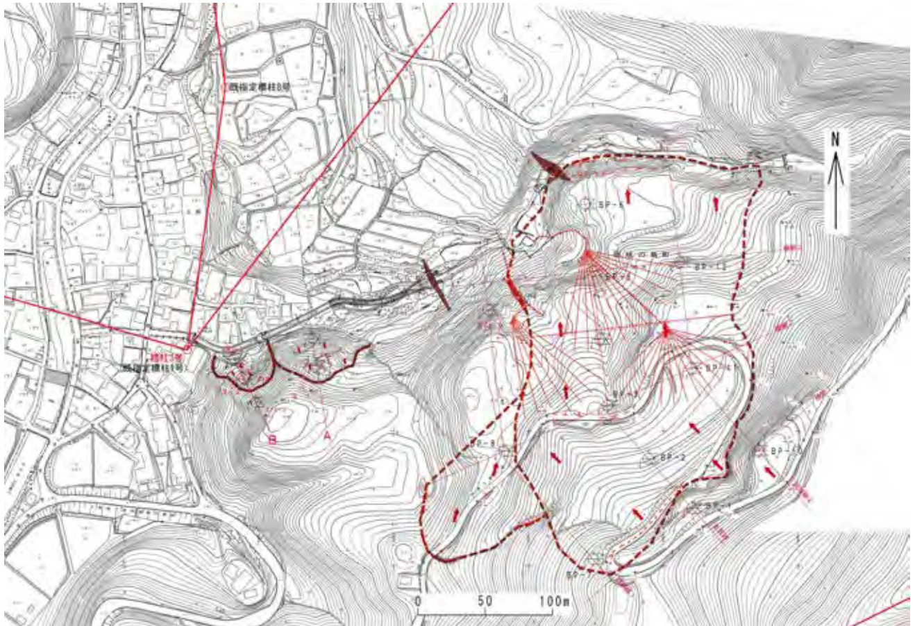
図 1.2.7 平成 18,19 年度の地すべりブロックと平成 19 年度緊急砂防のダム位置
