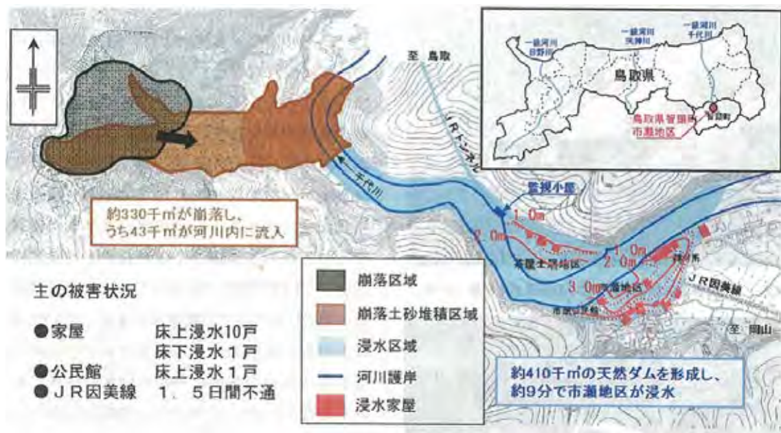
図2.3.14 被害状況図 (安本, 2005 より)
