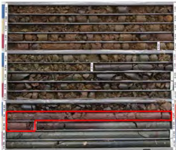
写真1.2.43 Gブロック(下段ブロック)のボーリングコア G.L.-11～-12.2 mに赤紫色の変質凝灰岩が分布し、すべり面を形成している。
