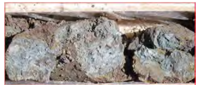
写真1.2.82 すべり面(BP-3; G.L.-9.6～9.8 m) この深度で鏡肌と条痕が明瞭なすべり面が確認された。
