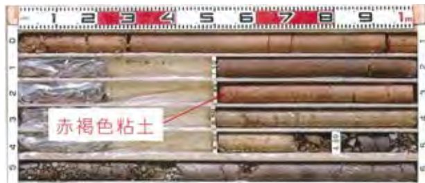
写真1.2.40 風化で赤褐色化し、粘土化が進んだ基盤層コア
