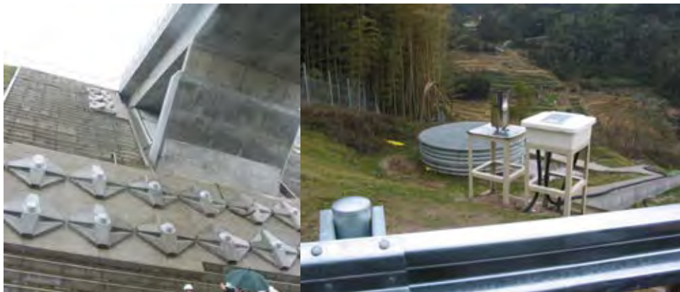
写真1.1.5 地すべり地帯に施工した高速道路沿いの計測機器 山陰自動車道宍道JCT付近。
