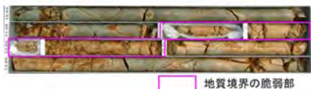
写真1.2.35 ボーリングコアに見られる花崗閃緑岩とそれを貫く岩脈 地質境界の上位が岩脈のデイスাইト，下位が花崗閃緑岩。
