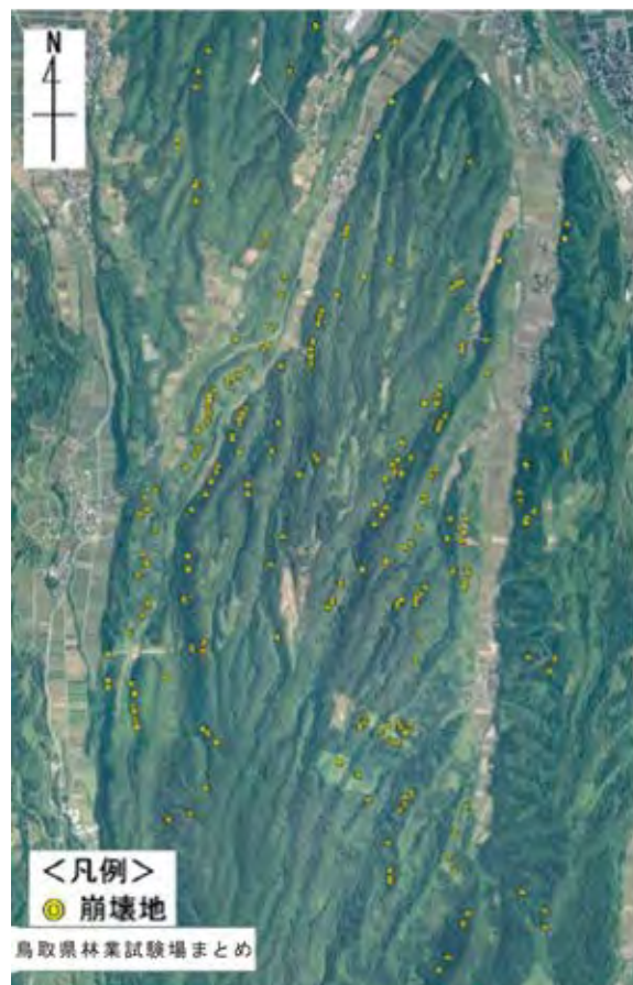
写真2.3.9 崩壊箇所の分布状況
