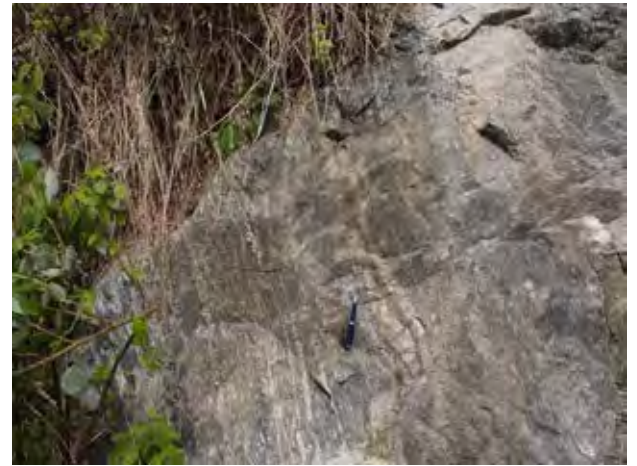
写真 3.3.6 銚子ダムサイトのミグマタイト質片麻岩の露頭。片麻状構造に平行に注入する優白色花崗岩と斜交する優白色花崗岩がみられる。
