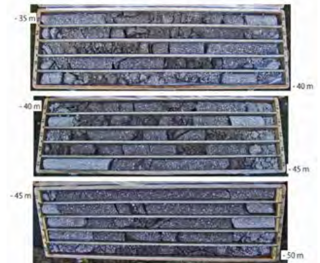
写真3.3.12 男三瓶北方, 図3.3.18のA地点における地表から-35~-50 mの掘削コア試料 岩石はデイサイトであるが, いずれも著しく破碎されている。
