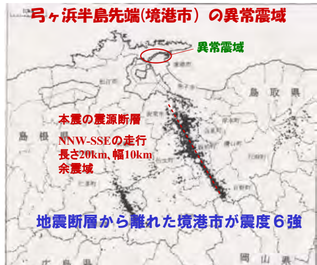
図3.2.6 2000年鳥取県西部地震の余震分布 本震の震源断層はNNW-SSE走向で、長さ約20km、垂直右横ずれ断層を示す。誘発地震が“割算型”に発生している。
