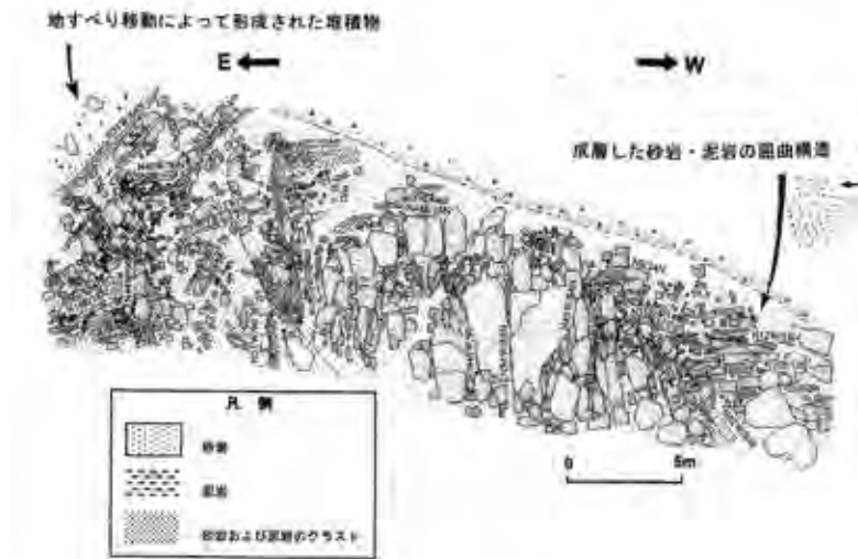
図1.1.13 島根半島海岸に見られる地すべり末端部の堆積物（角礫）と屈曲構造の例（出雲市） （熊谷・横田，2003）
