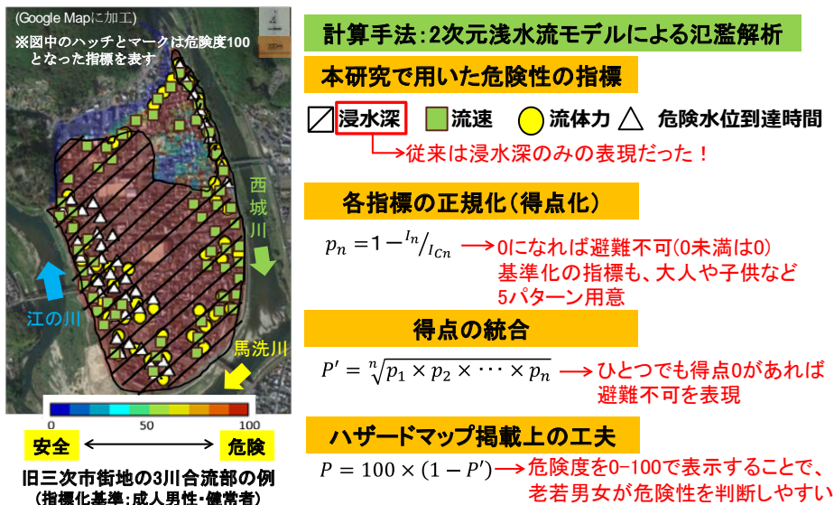
図2 マルチな指標を用いた新しい洪水ハザードマップ（旧三次市街地の例）
